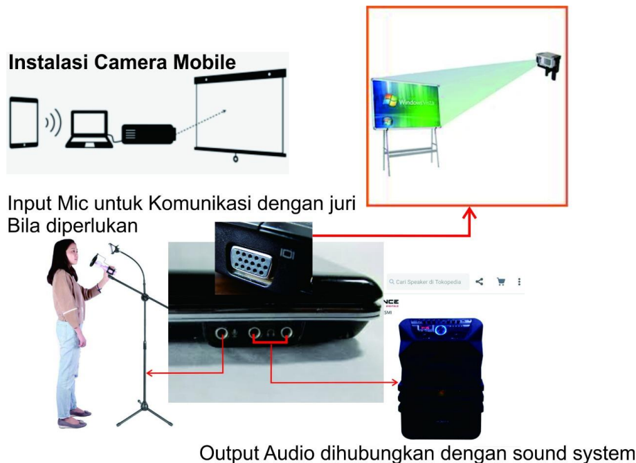
Gambaran Instalasi pemasangan kamera dan sound system
