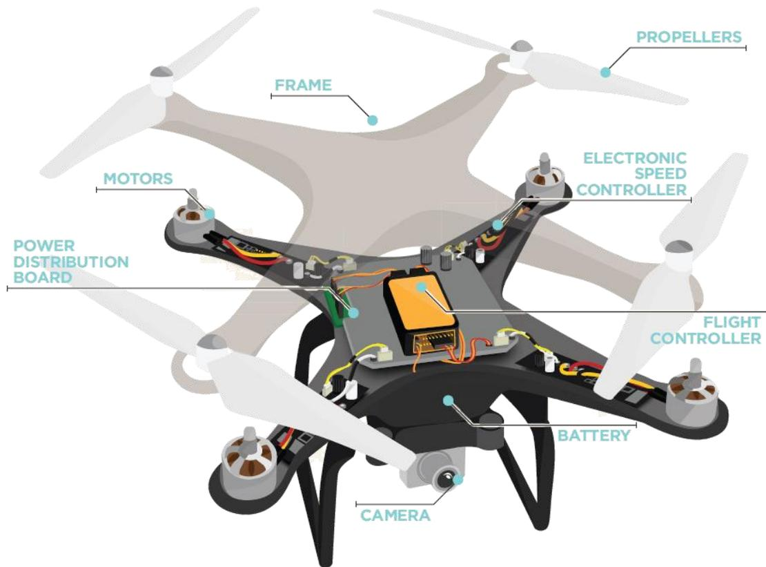
Prototipe yang dimodelkan dalam Bidang Lomba *Prototype Modeling* LKS-SMK Nasional 2023 adalah sebuah *Quadcopter Drone*. Model tersebut memiliki bagian-bagian utama:
